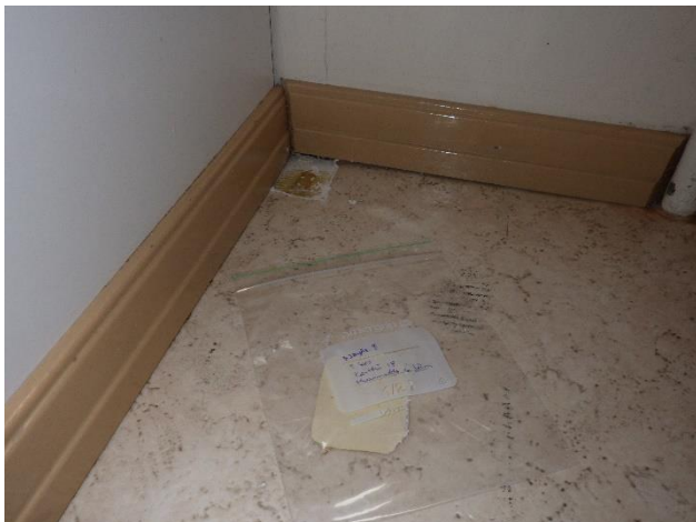
Kuva 10 keittiön 18 matto ei sisällä asbestia.
